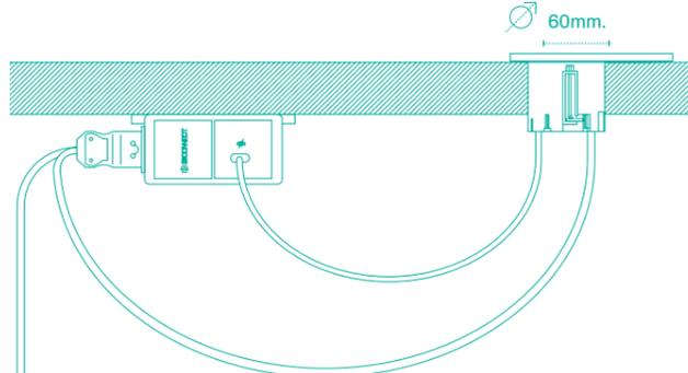
IT. Orbit è dotato di un cavo per il collegamento USB (del tipo A o C) che consente una connessione rapida e semplice al trasformatore di carica (Docking).
